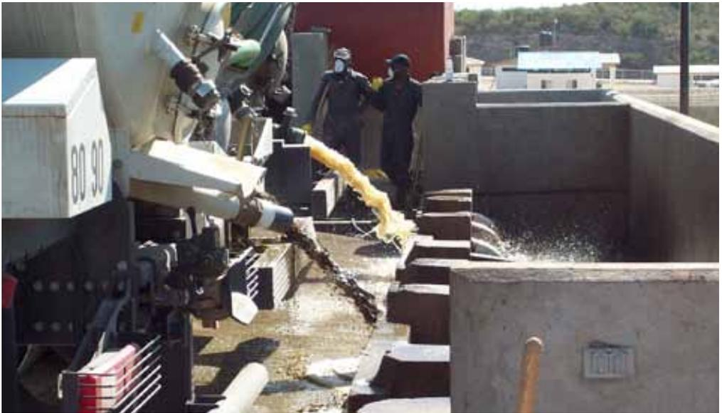
Dépôt des boues vidangées par camion au niveau de la station de traitement de Morne à Cabrit (Port-au-Prince, Haïti).
